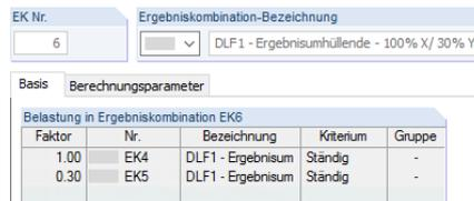
**Bild 5.17:** Kombinationsschema für die Überlagerung der Ergebnisse aus den einzelnen Anregungsrichtungen, hier wird die 100% / 30% Regel angewendet.
