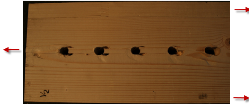
Bild 16.60: Blockscherversagen (Quelle: Tragfähigkeit von Brettsper Holz ; H.J. Blaß, T. Uibel)
