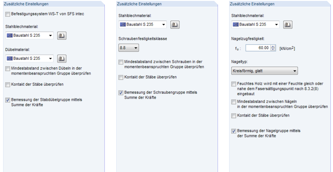
Bild 9.12: Abschnitte Zusätzliche Einstellungen für Stabdübel, Bolzen/Schrauben und Nägel
