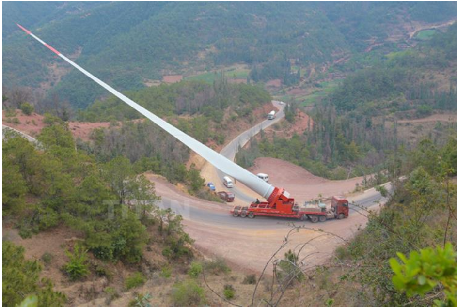
Εικόνα 2.13: Μεταφορά πτερυγίου Α/Γ σε πλαγιά βουνού από ειδικά διαμορφωμένο όχημα (Engström, Lyrner, Hassanzadeh, Stalin, & Johansson, 2010).
