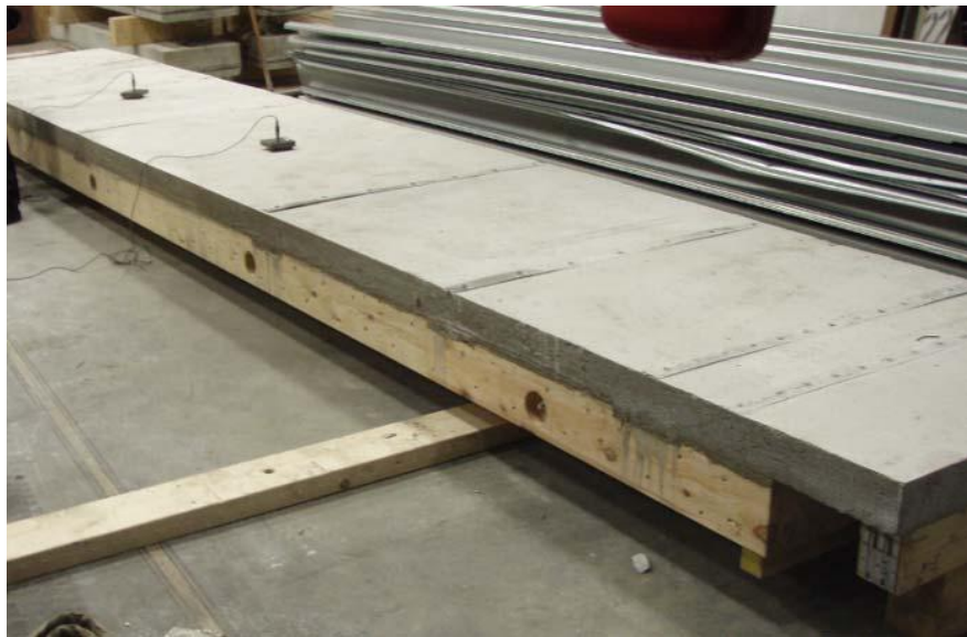
Abb. 2.8 Brettstapelholz-Beton-Verbundkonstruktion gemäß der Beschreibung von Kapitel 2.3 (Quelle: Winter, S.; Kreuzinger, H.; Mestek, P.: Teilprojekt 15 – Flächen aus Brettstapeln, Brettsperrholz und Verbundkonstruktionen. München, TU München. siehe auch [48])
