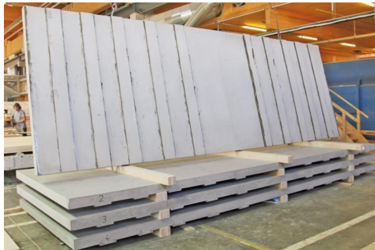
Abb. 2.5 Betonfertigteile für den Einbau in einer Brettstapelholzbetonverbunddecke
