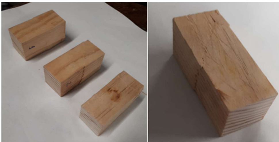
Ilustración 17. Probetas tras el ensayo a compresión
