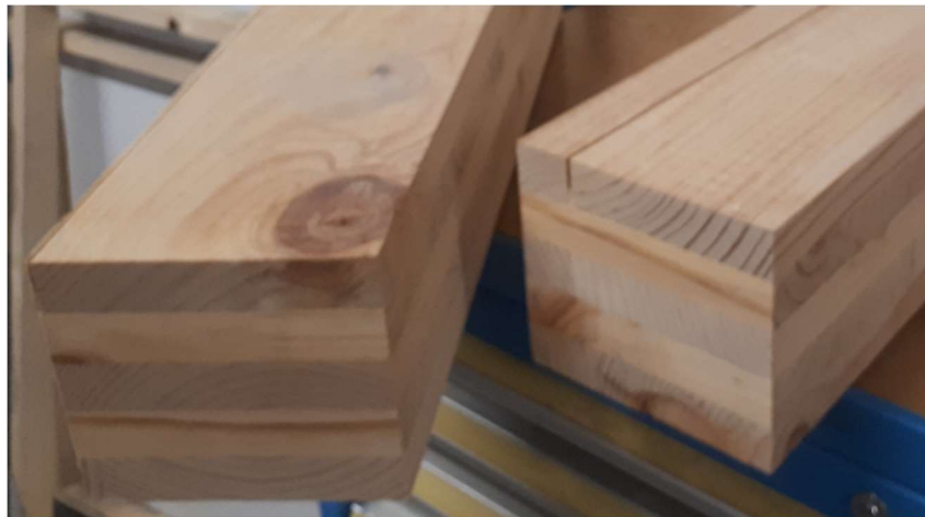
Ilustración 18. Probetas de CLT para el ensayo a flexión
