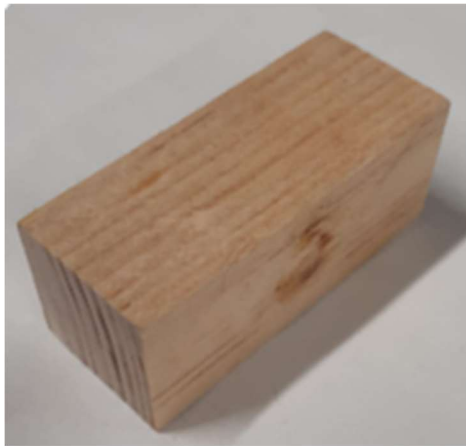
Ilustración 15. Probeta de madera del ensayo a compresión
