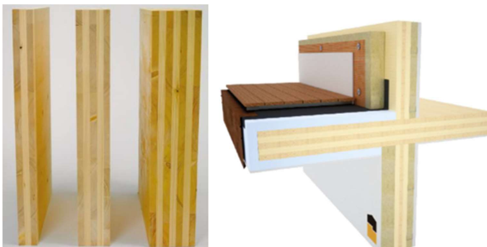
Ilustración 7. Sección de los muros de CLT
