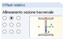
Selezionando il punto al centro dell'ala superiore, come mostrato nell'immagine a sinistra, si può attaccare per esempio una trave orizzontale con il suo bordo superiore ad una colonna tramite il collegamento a filo (senza estensione).
