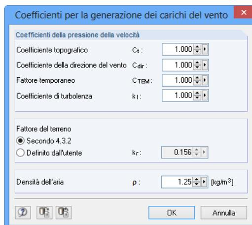
Figura 11.197: Finestra di dialogo *Coefficienti per la generazione dei carichi del vento*
