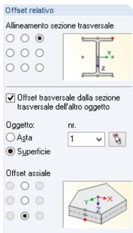
Definendo i punti sul bordo dell'ala superiore e sul lato inferiore della superficie, come mostrato nell'immagine a sinistra, è possibile disporre, ad esempio, una sezione trasversale d'acciaio sul bordo sotto una piastra tramite un collegamento a filo.
